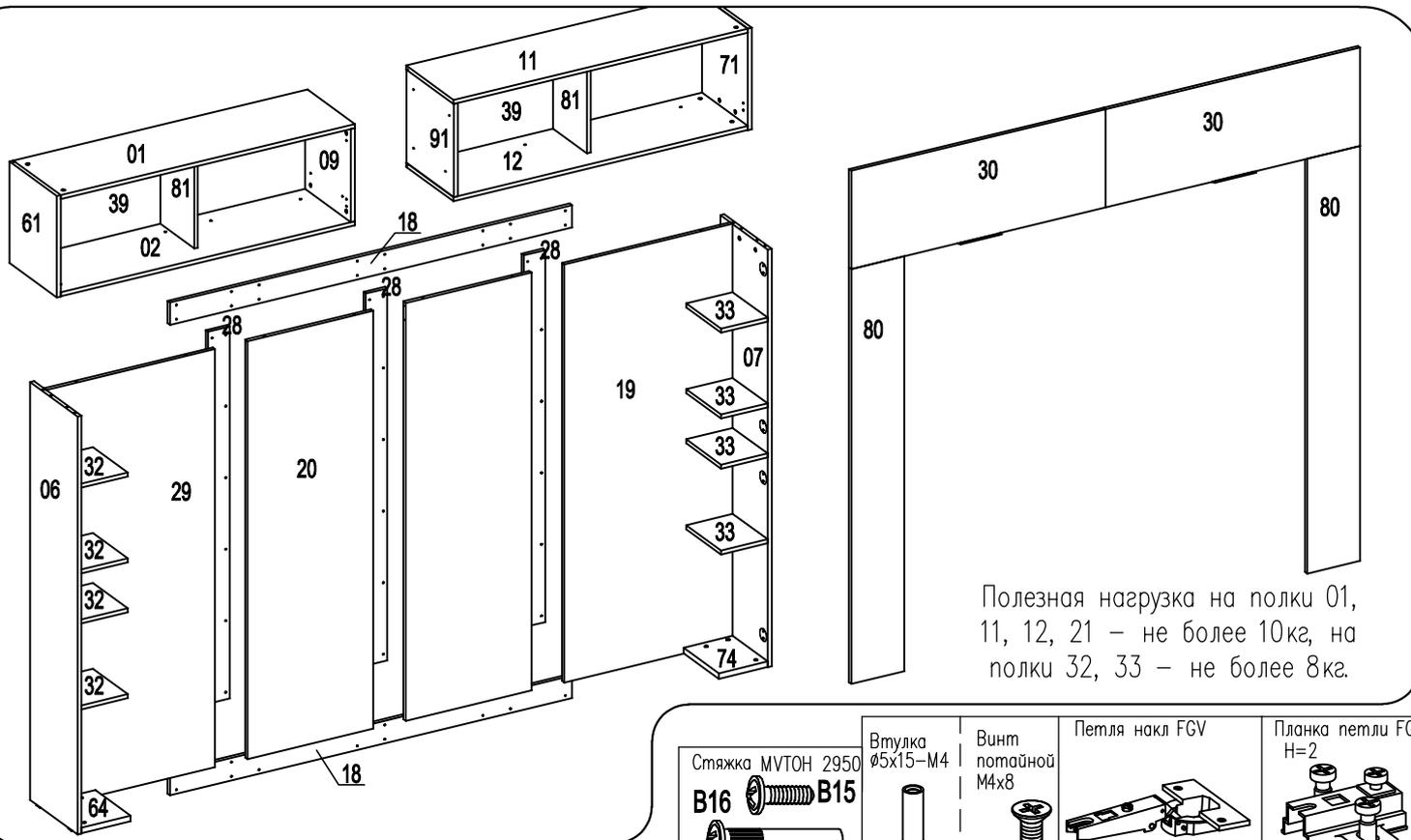
Полезная нагрузка на полки 01, 11, 12, 21 – не более 10кг, на полки 32, 33 – не более 8кг.
